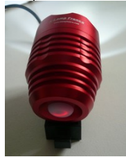
Fin de Batterie (à remplacer rapidement)
